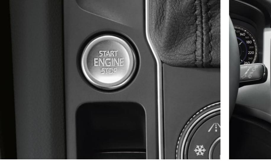
Система бесключевого доступа и запуска двигателя Keyless Access
