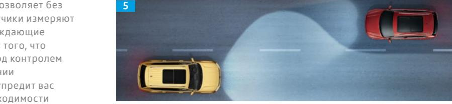
5 **Система автоматического управления дальним светом Light Assist**
